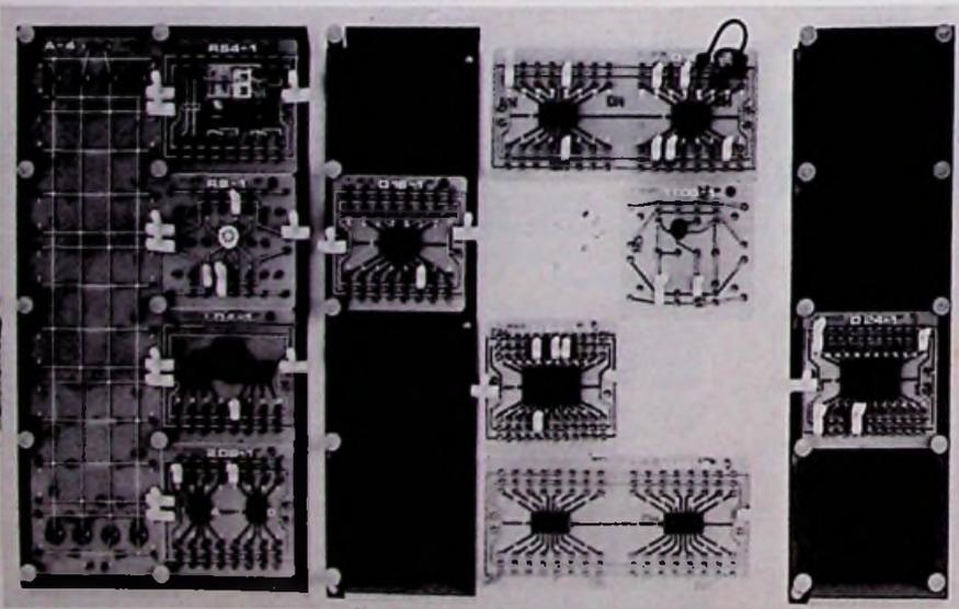
gebunden und kann nach individuellen Wünschen zusammengestellt werden. Ein besonderes Anleitungsbuch ist nicht erforderlich, es können laut Hersteller alle auf dem Markt befindlichen Anleitungen für den Aufbau integrierter und diskreter Schaltungen verwendet werden
