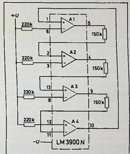
Die Schaltung des Multivibrators: Als phasenschiebende Elemente dienen die vier integrierten Operationsverstärker
