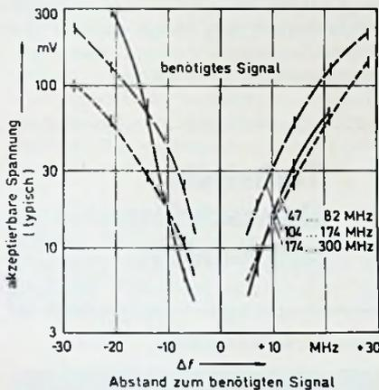
Kurven für eine Kreuzmodulation von 1% in Abhängigkeit von Pegel und Frequenz des Störers
