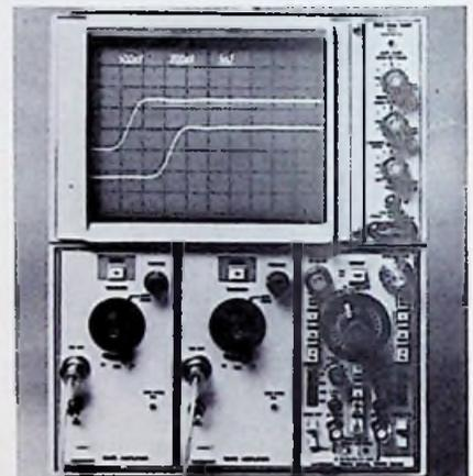
Der 60-MHz-Zweistrahlozilloskop 5444 von Tektronix, abgebildet mit dem Doppelzeitbasis-Einschub 5B44.
