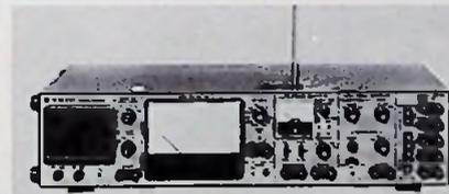
Beim neuen Universal-Hi-Fi-Testgerät von Trio lassen sich fünf eingebaute Meßgeräte ohne externe Kabel miteinander verbinden.
